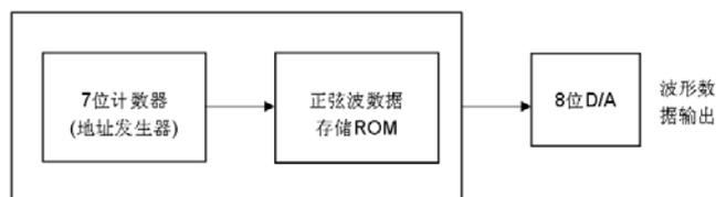
图 4-59 正弦信号发生器结构框图
