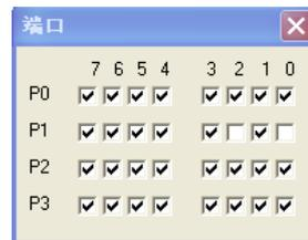
图 5-15 P1 端口输入/输出
